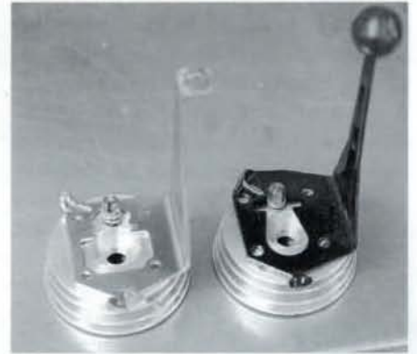
Bij de verbeterde cilinderkop met centrale bougie is ook een in eigen beheer gemaakte rvs motorlifter ontwikkeld
