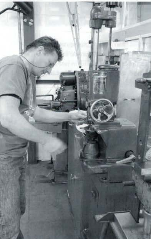
Cilinders opboren is een oud ambacht aan het worden. Gelukkig is Marcel nog geen oud rimpelig mannetje...
